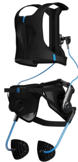
Figuur 1 De Laevo FLEX is een voorbeeld van een exoskeleton dat je rug ondersteunt.
